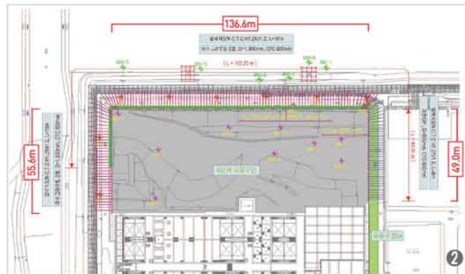
N치 50이하의 불량한 지반 및 전석층에서의 압력식 쏘일네일링 흙막이 벽체 시공
